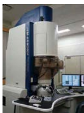
名古屋工業大学 NI-001 原子分解能分析電子顕微鏡群
