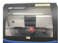
UVプリント基板加工装置(ProtoLaser U4)でアンテナを作製
