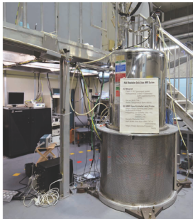
500MHz固体汎用NMRシステム 磁場: 11.75[T] 4mmHX, HXY, 3.2mmHX, Staic その他特殊プローブ MAS: 15~20kHz
