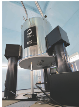
800MHzWB固体高分解能NMRシステム(内部専用) 磁場: 18.79[T] 1mmHX, 2mmHX, 3.2mmHX, single, Low- \gamma , Static MAS: 20~70kHz
