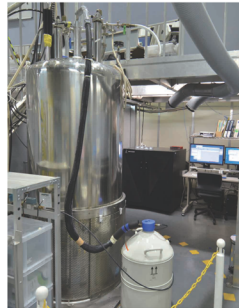
500MHz固体高分解能NMRシステム 磁場: 11.75[T] 4mmHX, HXY, 3.2mmHX, Staic, 温度可変(-100~200°C) MAS: 15~20kHz
