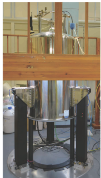
800MHzNB固体高分解能NMRシステム 磁場: 18.79[T] 3.2mmHX, single, Low- \gamma , Static MAS: 20kHz
