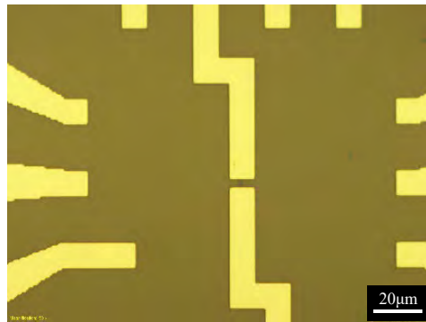
図 6 Au/Cr の蒸着・リフトオフ後
