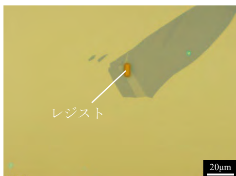
図 3 チャンネルパターンのマスクレス露光・現像後
