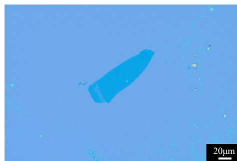
図 2 SiO 2 が 300nm の基板に転写したグラフェン
