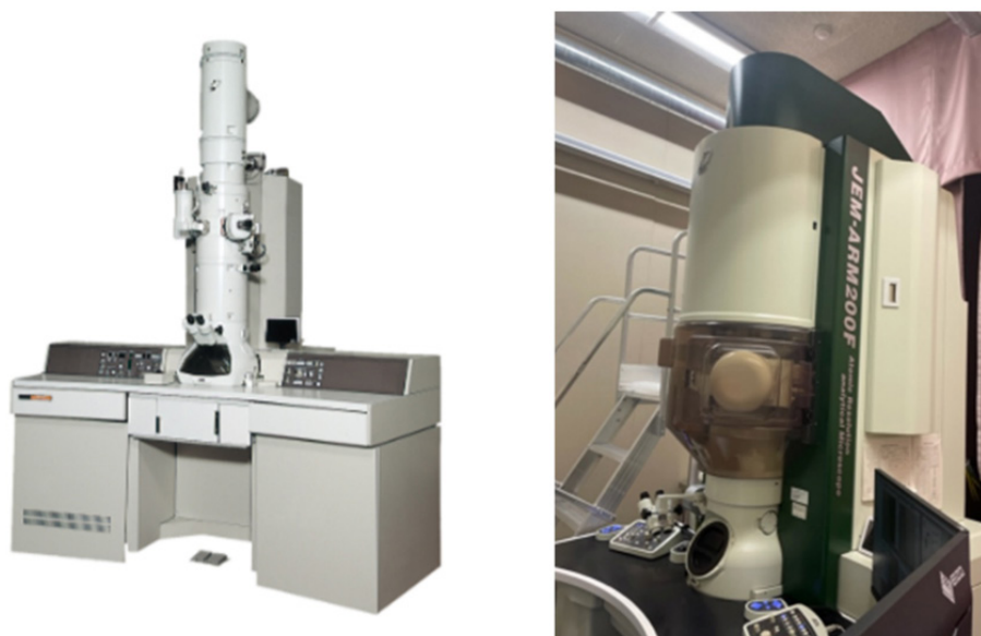
図 4 \text{Y}_2\text{Ti}_2\text{O}_5\text{S}_2 粒子観察に利用した TEM, STEM 左) TEM, JEM-2010HC, JEOL, 右) Cs-corrected thermal FE-STEM, JEM-ARM200F, JEOL
