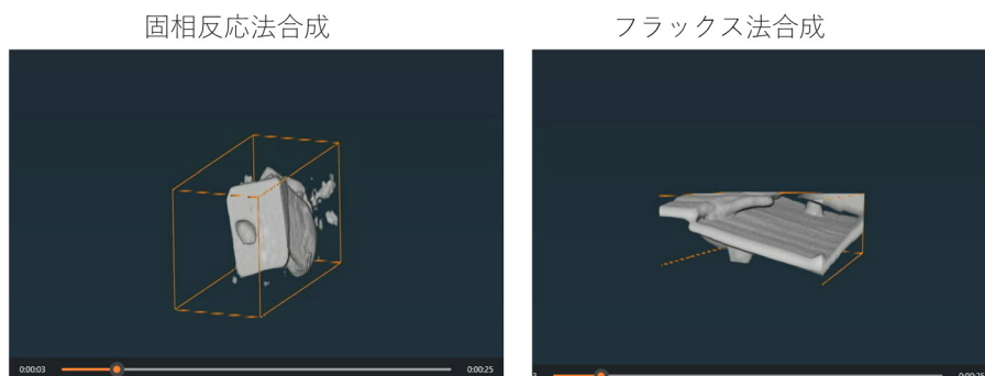
図 3 \text{Y}_2\text{Ti}_2\text{O}_5\text{S}_2 粒子 FIB-SEM スライスアンドビュー 3D 構造解析結果動画一部 左) 固相反応法合成, 右) フラックス法合成
