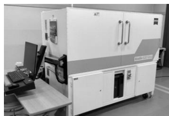
図 2 3 次元高分解能 X 線顕微鏡。 非破壊の断面構造解析を行う。
