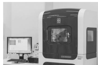
図 1 ナノインデント。 STM を応用した nm サイズの 押し込み試験機。
