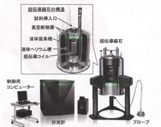
図3 NMR 装置の構成 [13]
