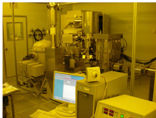
図3 作製に使用した東京工業大学の電子ビーム露光装置
