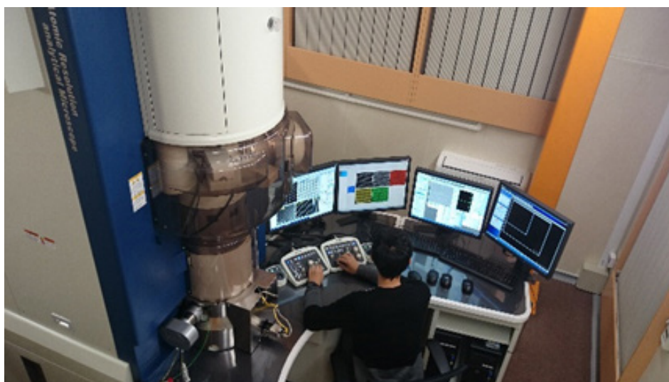
図1 測定に用いたモノクロメータ搭載低加速原子分解能分析電子顕微鏡 JEM-ARM200F
