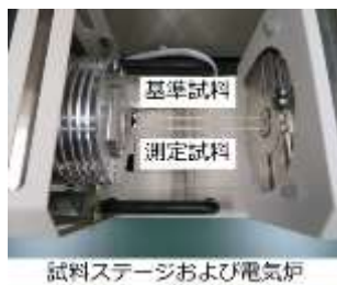
図 3. 試料ステージおよび電気炉
