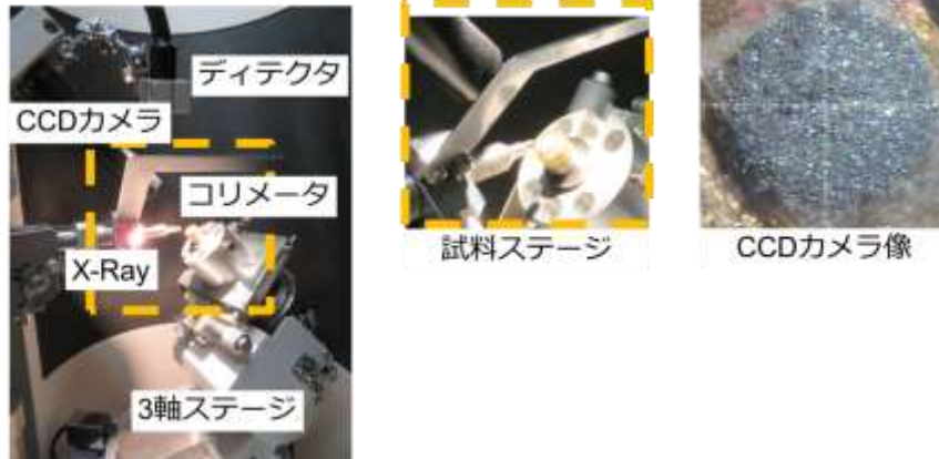
図 2. 装置の主要部の写真, 試料ステージの写および CCD カメラの試料画像
