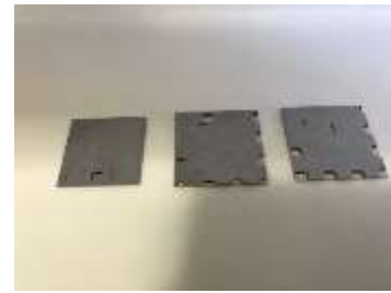
画像 4. 約 12 時間後のダイヤフラムの凹み
