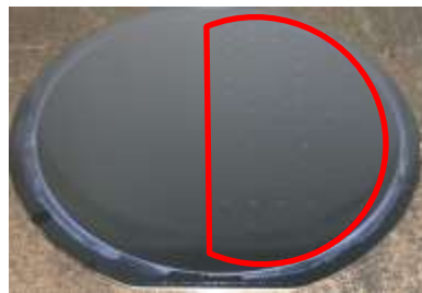
画像 3. 接合直後のダイヤフラムの凹み
