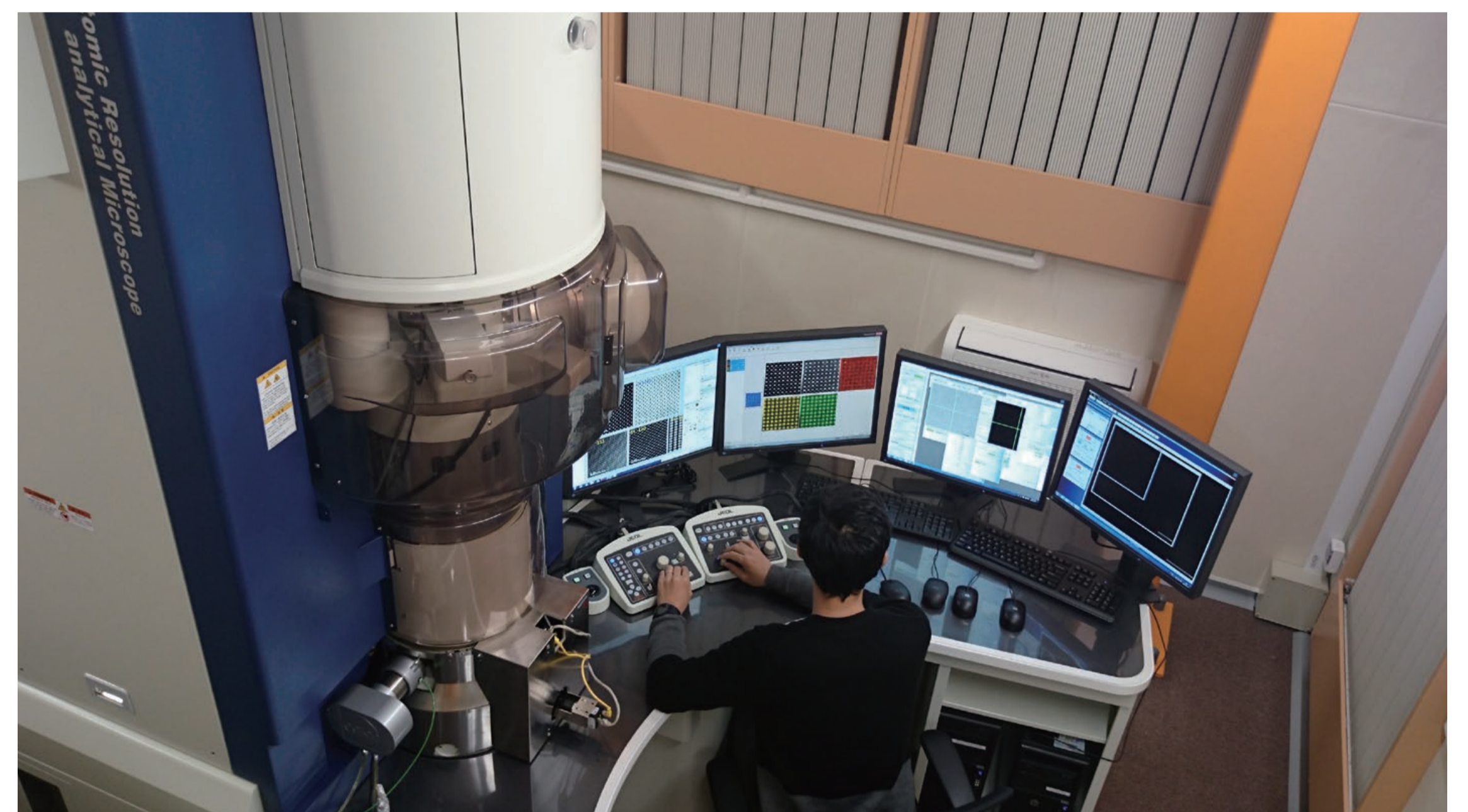
図1. モノクロメータ搭載低加速原子分解能分析電子顕微鏡
