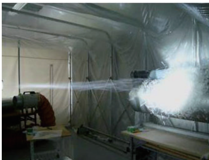
図6 Zs方式の熔融型量産装置によるナノファイバー大量生成の実験状況 (提供：谷岡氏)
