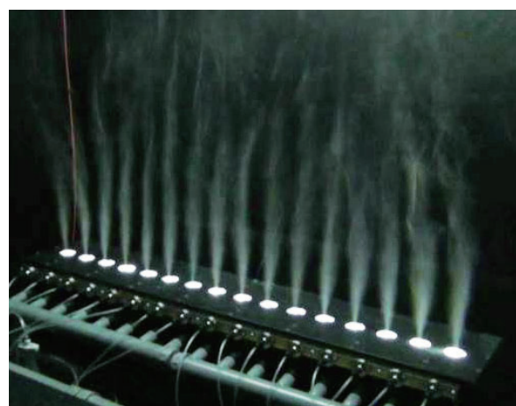
図4 電界紡糸装置の 16 連ノズルから吐出するポリウレタンナノファイバー (提供: 谷岡氏)
