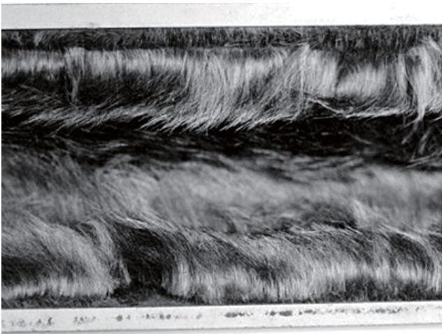
図3 円筒状のセラミック基板を用いたカーボン繊維の生成状況 (提供：信州大学 遠藤守信先生)
