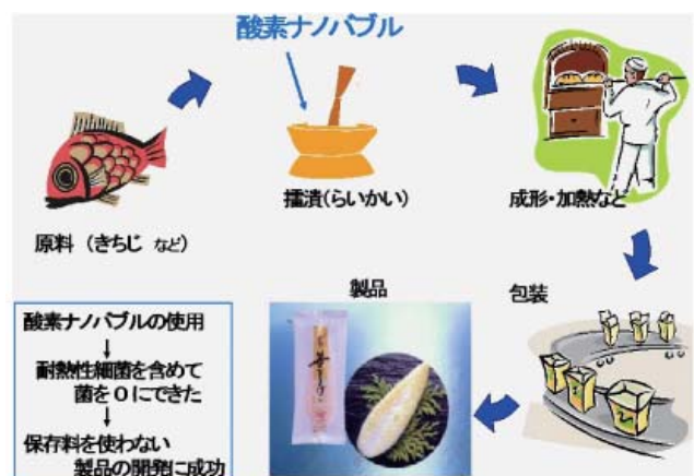
図 17 ナノバブルを利用した薬剤無添加蒲鉾の製造
