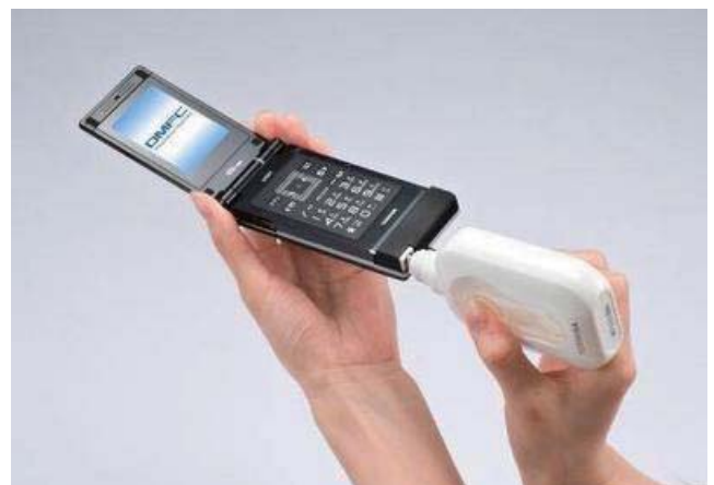
図 1 ダイレクトメタノール型燃料電池を搭載した携帯電話（提供：東芝）（携帯電話内の燃料タンクへ燃料カートリッジからメタノールを補給しているところ。携帯電話は稼動中）
