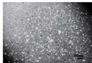
図13 Cu ナノボールの透過電子顕微鏡写真 分布組織 (暗視野像).
