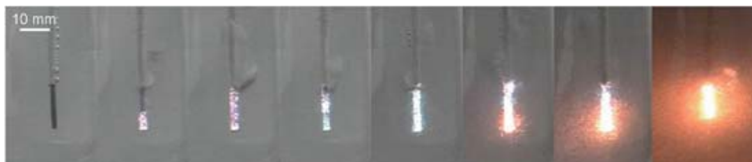
図5 印加電圧の上昇と共に成長するプラズマの様子 [陰極 Ni (1.5mm \Phi )]。
