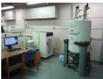
消臭効果解明のため分子の相互作用の評価に使用しているNMRスペクトル測定器
