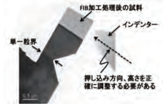
図7 試料と負荷チップのTEM像
