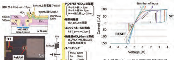
図3 試作デバイス構造図（断面）及び写真 (ReRAM付トランジスタ) 図4 試作デバイスの基本特性測定結果
