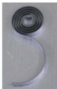
リリースした 字ぜんまい Released S-shaped spiral spring
