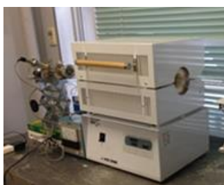
図1 窒素ドーピンググラフェンのCVD合成装置
