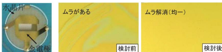
図3 QCMセンサ電極部(左)と脂質溶液塗布後の金電極表面の顕微鏡写真。条件検討前(中央)、検討後(右)
