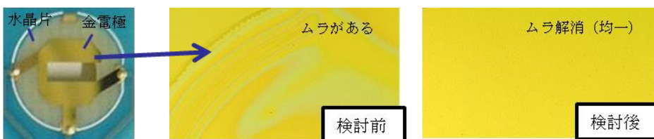
図3 QCMセンサー電極部 (左) と脂質溶液塗布後の金電極表面の顕微鏡写真。条件検討前 (中央)、検討後 (右)
