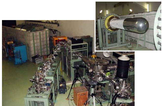
図2 ラザフォード後方散乱(RBS)測定装置
