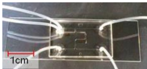
図2 表面プラズモン共鳴を用いたノロウイルス用センサ
