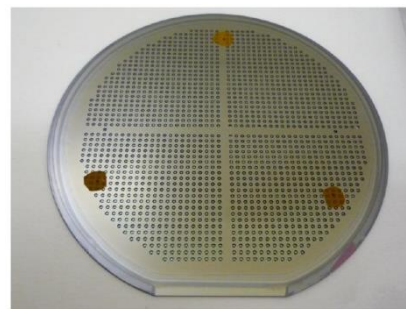
図2 深堀りドライエッチング後のウェハ写真 (ウェハ裏面側)
