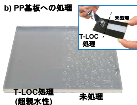
図1 弊社T-LOCプロセス：有機ケイ素化合物の混合燃焼炎によるフレイム溶射(a)により、様々な基材へ、超親水性、高接着性、高密着性を付与する(b)表面処理技術。また、効果持続性が高い特徴がある。
