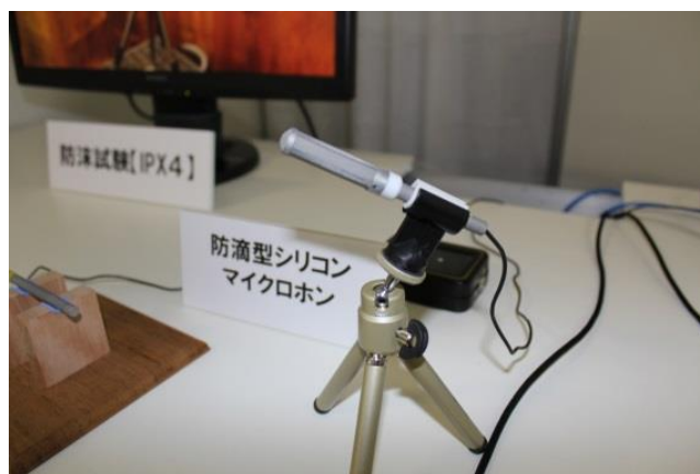
図2 NHK放送技術研究所「技研公開2013」において一般公開された、防沫仕様1/4インチ小型マイクロホン
