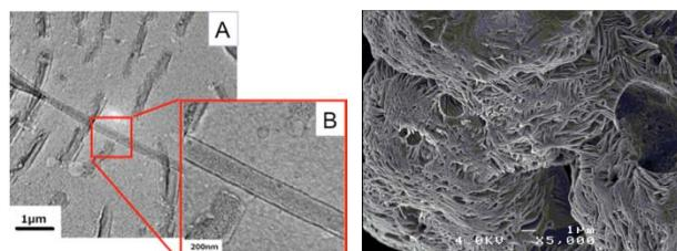
図3 GFPナノチューブのTEM画像(左)と SEM画像(右)
